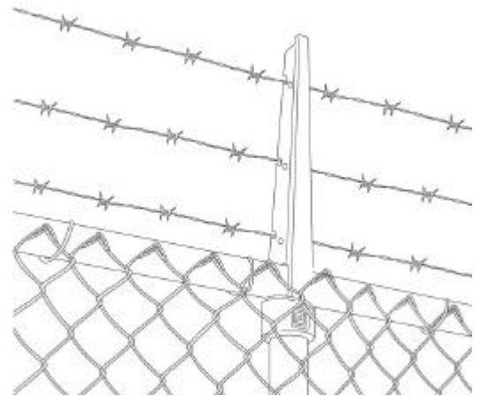
Tussenpaal + rechte opstand (Ø 48 of Ø 60 mm in alu of groen gepl.) + bovenbuis
